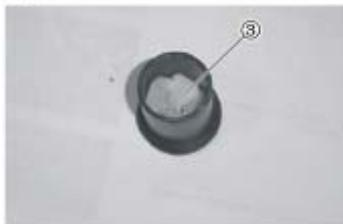
Reinstale el filtro limpio o nuevo en orden inverso al de desmontaje.
